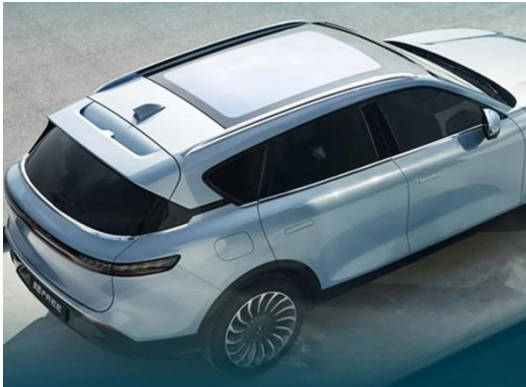
图15: 岚图 FREE PDLC 调光+镀膜隔热全景天幕
