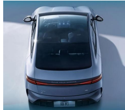
图16: 比亚迪海豹搭载 EC 调光+LOW-E 全景天幕
