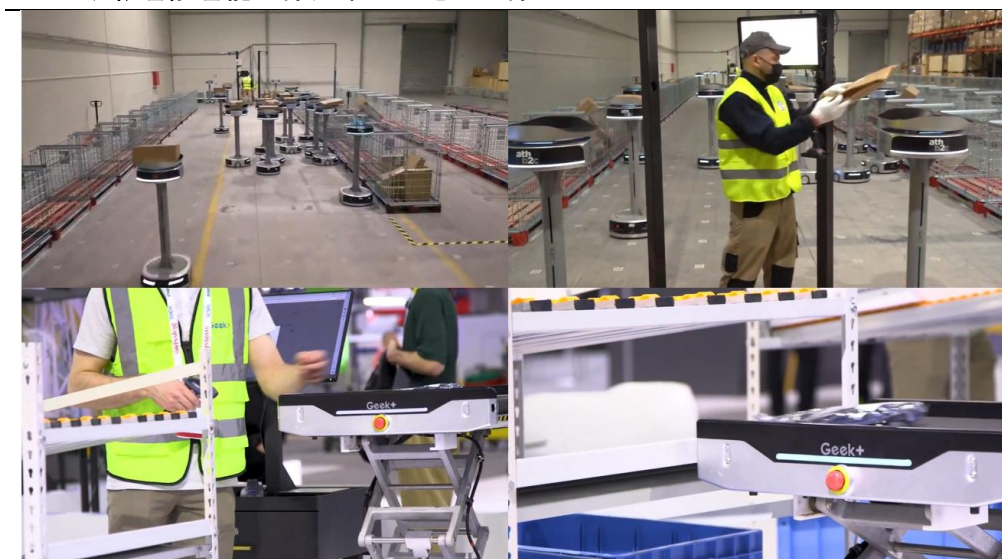
图38、极智嘉智能分拣方案——地面分拣示例
