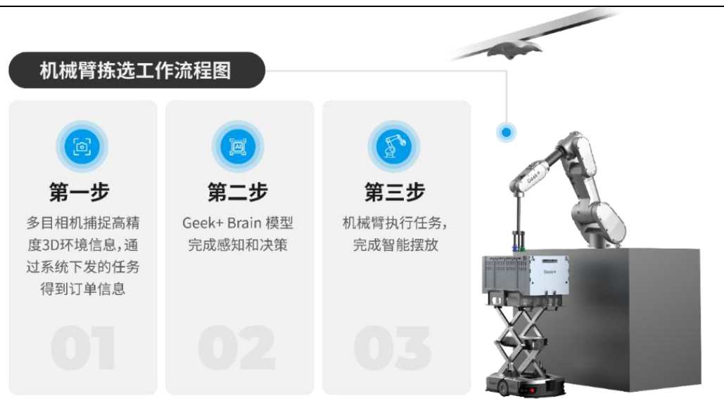
图21、极智嘉具身智能机械臂拣选工作流程
