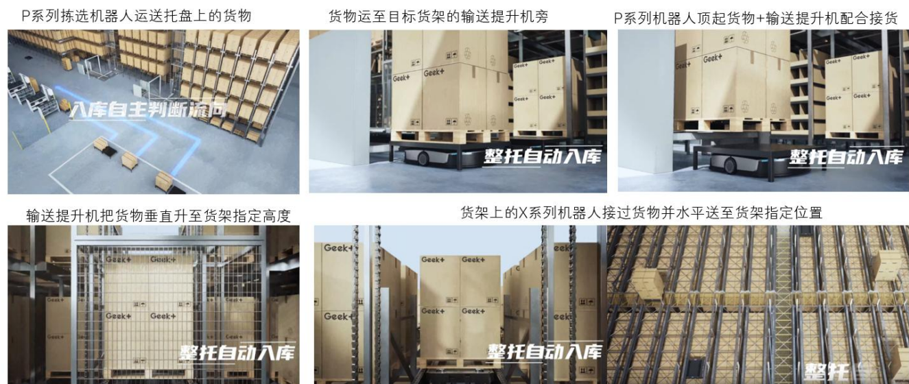
图36、SkyCube 解决方案机器人合作流程（以整托入库为例）
