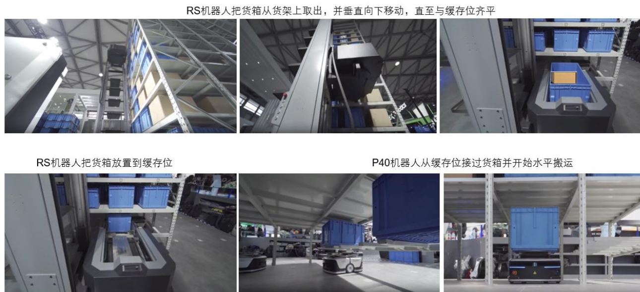
图33、货箱到人拣选 RoboShuttle 方案机器人合作流程（以取货为例）
