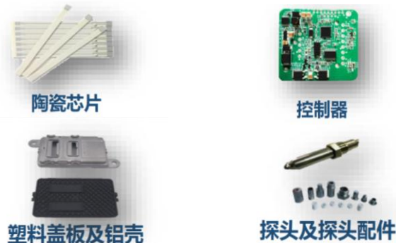
图16、公司氮氧传感器部件拆分
