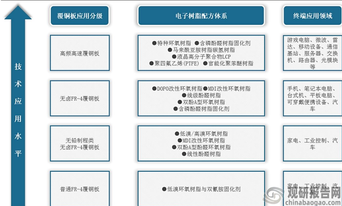
图表 19. 覆铜板技术应用水平及电子树脂配方体系
