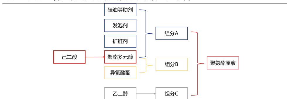
图 64、己二酸、聚酯多元醇为聚氨酯原液生产原料
