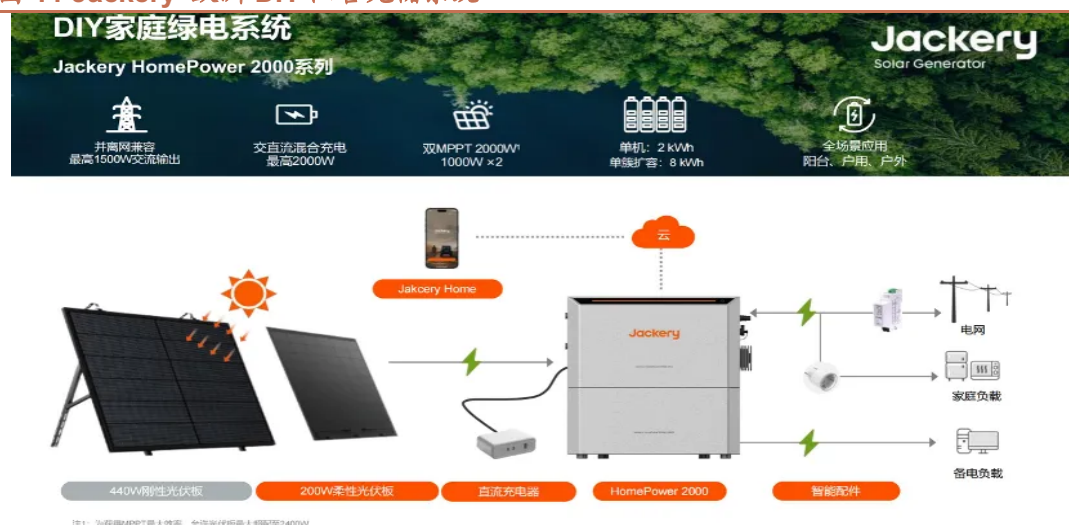
图 11 Jackery 欧洲 DIY 阳台光储系统
