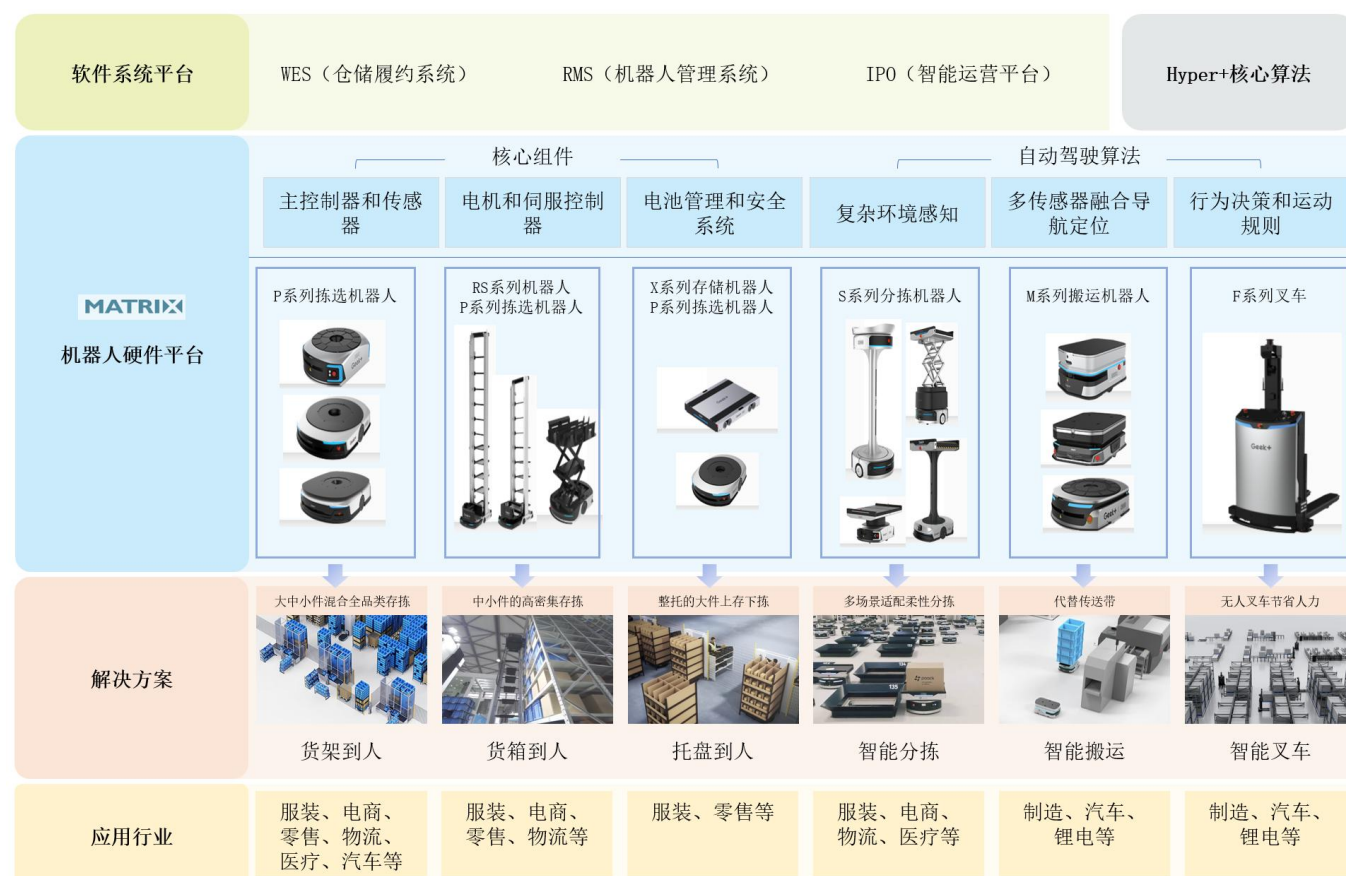
图2：极智嘉通过“硬件+软件+算法”的技术底座提供全面的 AMR 解决方案
