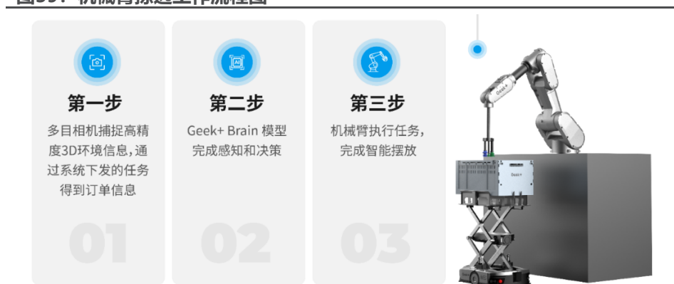
图39：机械臂拣选工作流程图
