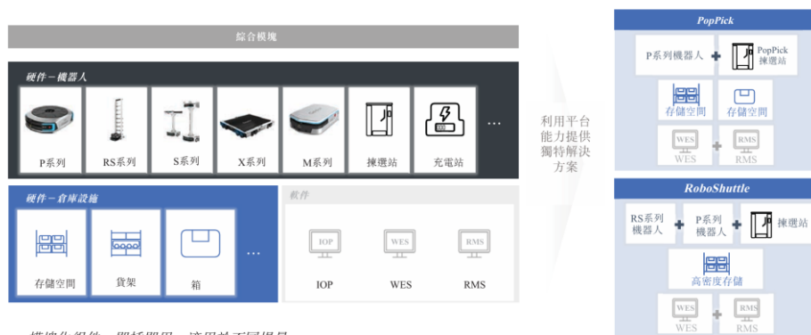
图9: 极智嘉的模块化设计方案
