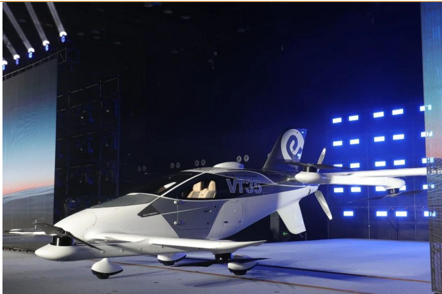
图 2：亿航智能 VT35 长航程无人驾驶载人航空器
