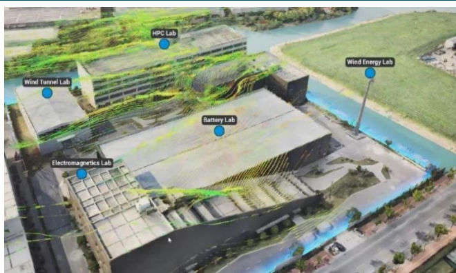
图表15：低空三维物理地图中风场流线数据实时生成
