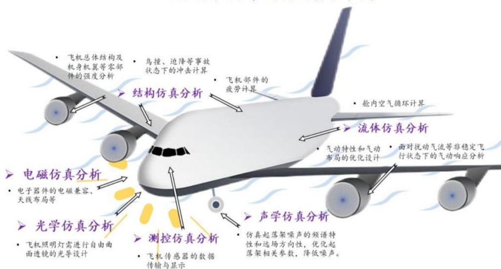
图表33：飞机设计过程中的典型仿真分析场景，涉及结构、流体、电磁等六大学科
