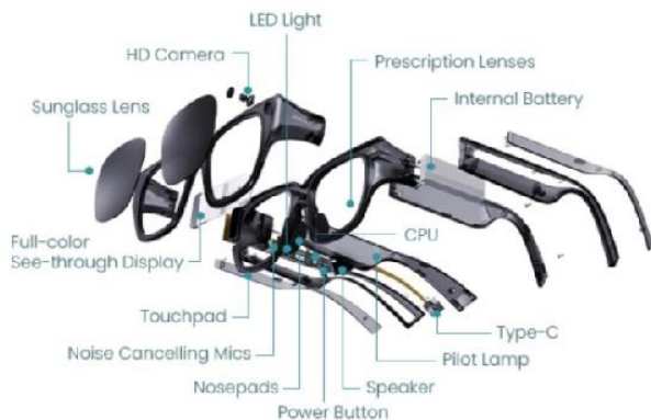
图 30：AR 眼镜结构拆分（INMO air 2）
