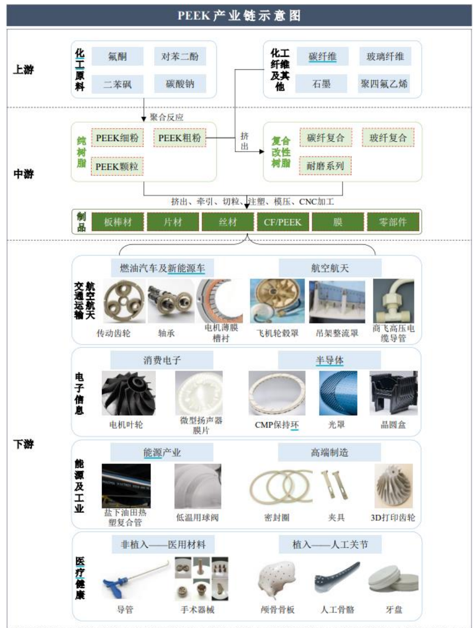
图15：氟酮为 PEEK 材料的主要原材料之一
