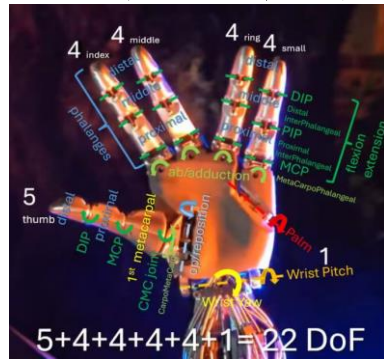
图：Optimus 灵巧手自由度提升至22个（对标人手约26个）
