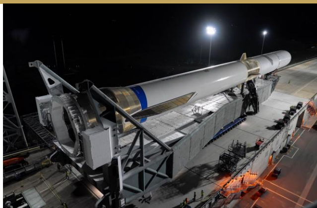
图7：Blue Origin的New Glenn火箭：两级设计、部分可重复使用的重型运载火箭
