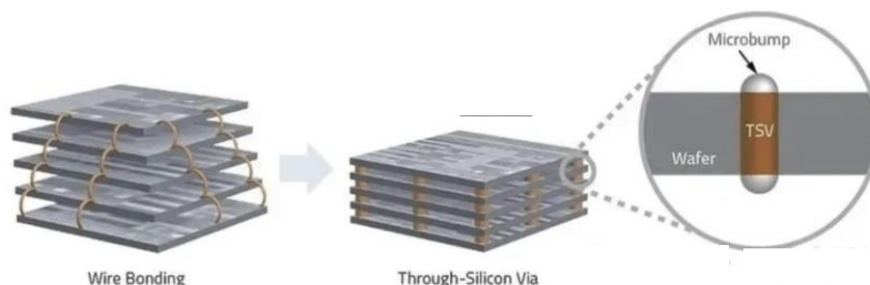
图35、TSV 技术的示意图
