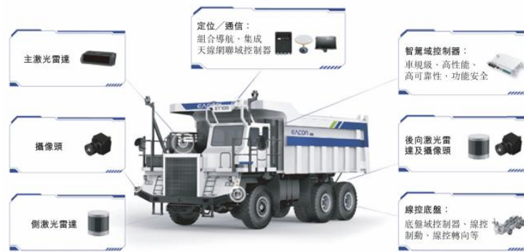
图21：无人驾驶矿卡的高精度传感器部件
