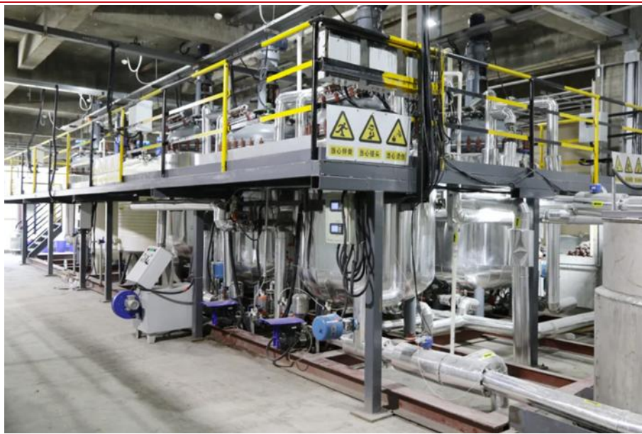
图表30: 山东临邑基地-“从复杂铝电解质中提取锂盐新技术”中试生产线
