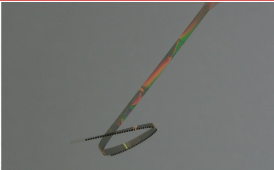
图表17：超柔性电极仅约头发丝的1/100
