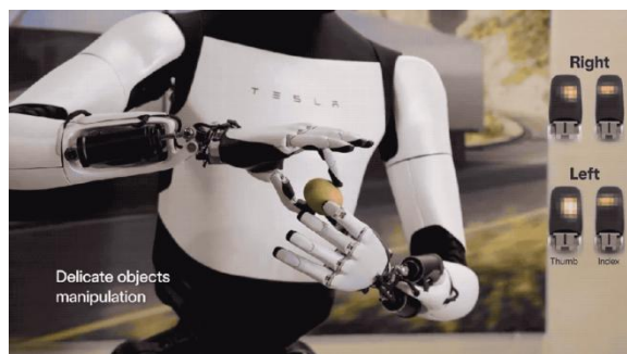
图12: 特斯拉 Optimus 实现鸡蛋灵活抓取
