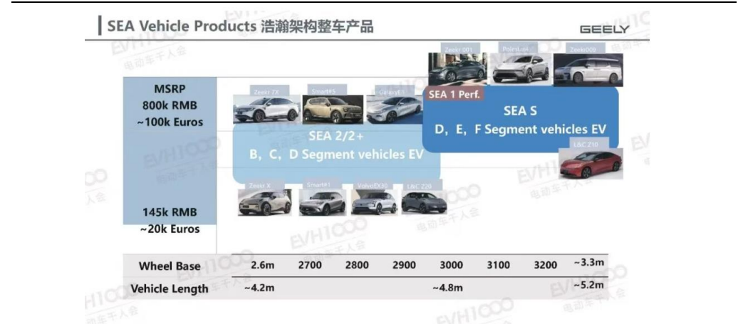
图59：SEA 浩瀚平台架构涵盖 A 到 E 系列不同车型
