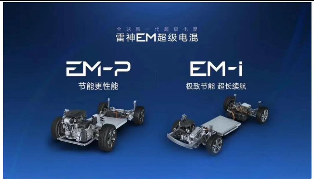
图61：雷神超级混动技术包含 EM-P 和 EM-i 两个版本，分别注重性能、经济性
