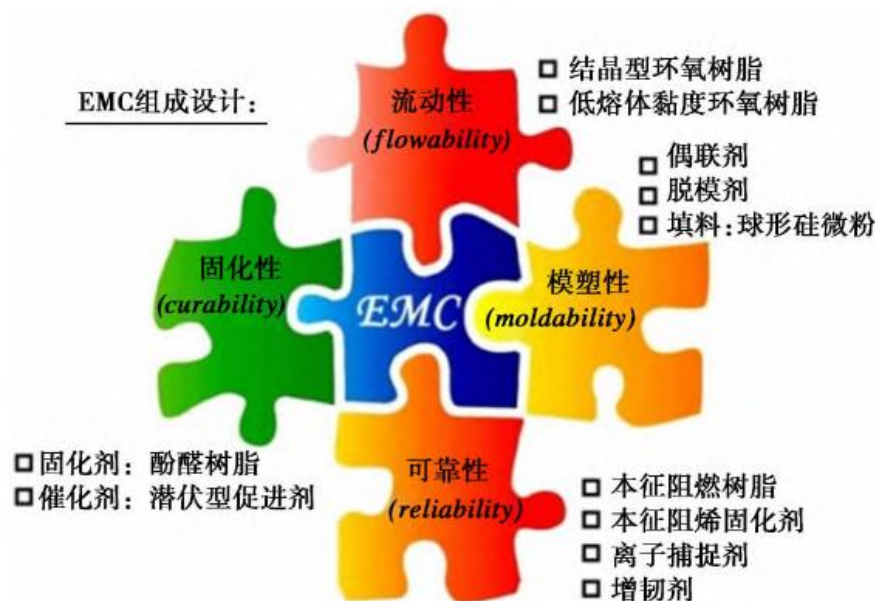
图表4：先进封装用 EMC 的组成设计及开发要点
