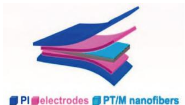
图 4：压电式触觉传感结构示意图
