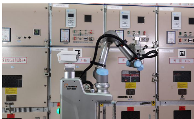
图 27：申昊科技开关室操作机器人应用场景图
