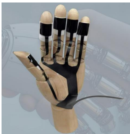
图 22：汉威柔性触觉传感器示意图
