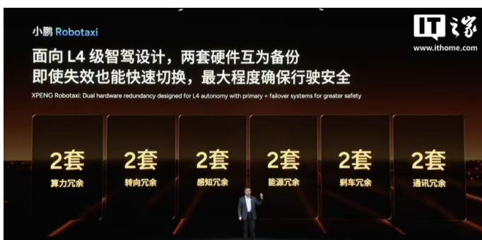
图11：小鹏 L4 智驾设计配有两套硬件保障安全
