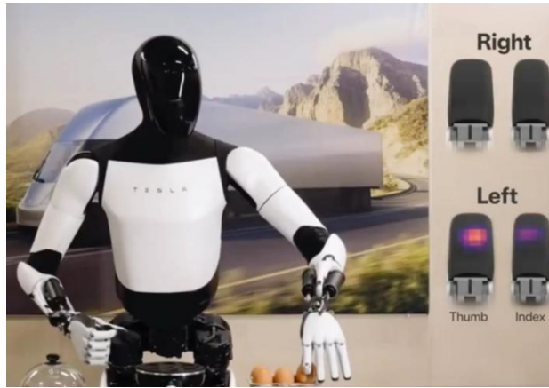
图3 特斯拉 Optimus Gen2：实现手拿鸡蛋的灵巧操作
