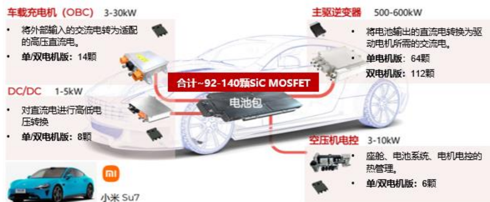
图表 6：新能源汽车 SiC MOSFET 单车需求量（以小米 Su7 为例）
