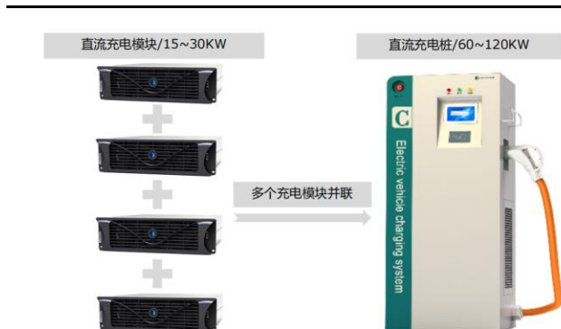
图表 10：直流充电桩通过增加电源模块的堆叠组来提升功率
