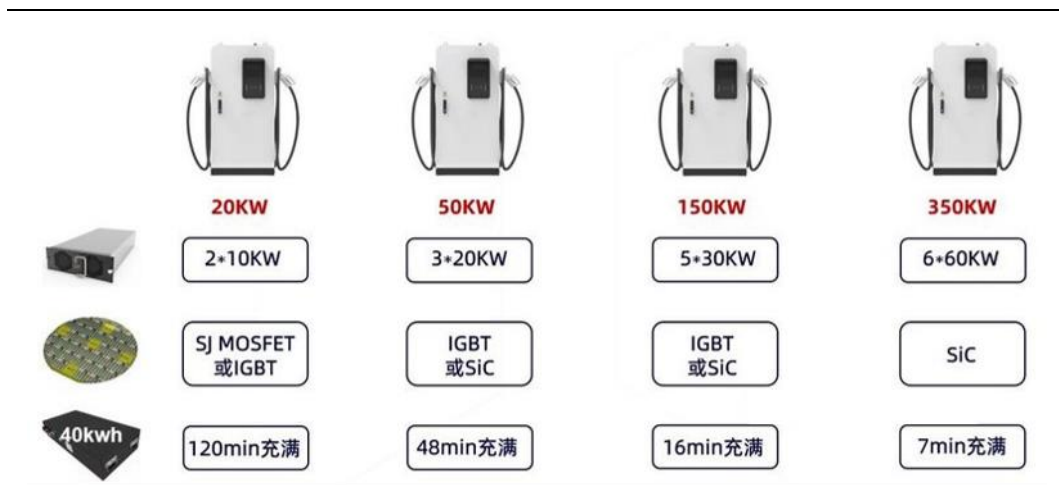
图表 9：新能源车充满电的时间随直流充电桩功率提升而缩短
