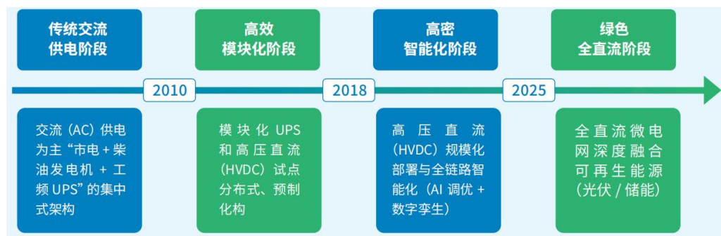
图表 14：AIDC 供配电系统向绿色全直流阶段演变
