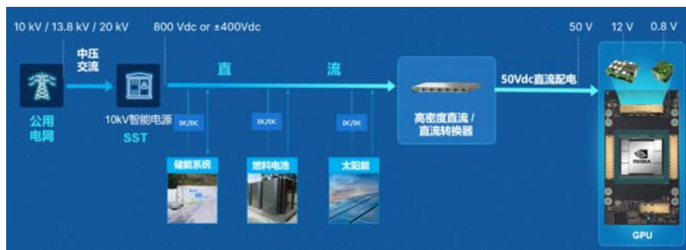
图表 24：SST 架构便于新能源系统并网
