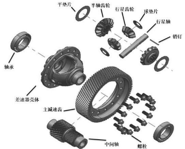
图表26: 新能源汽车电驱传动部件总成结构图
