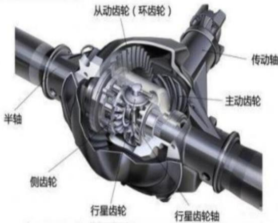
图表20: 汽车差速器结构图
