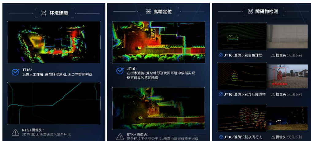
图79: RTK+视觉与激光雷达技术对比 (以禾赛 JT16 为例)
