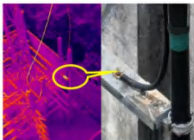
螺栓锈蚀、松动等金具缺陷
