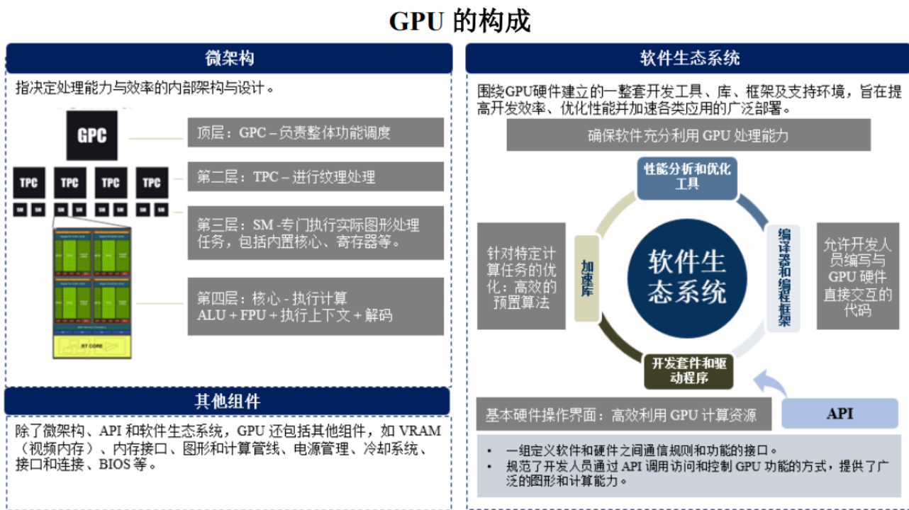
图表14: GPU 的关键组件包括微架构, 以及由开发工具、程序库和应用程序接口 (API) 组成的软件生态系统
