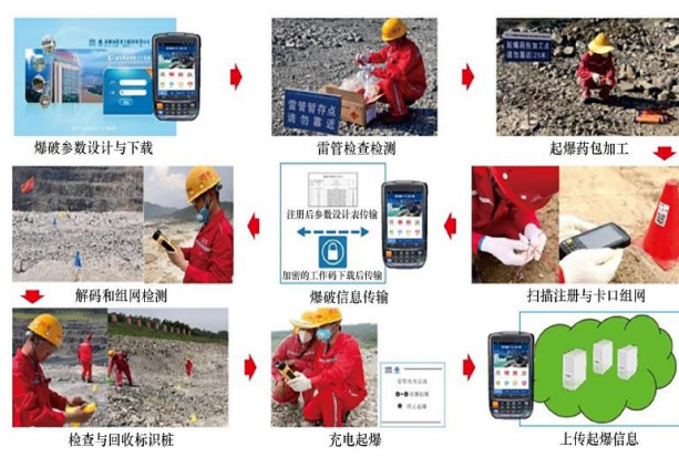
图 23：电子雷管起爆操作流程图
