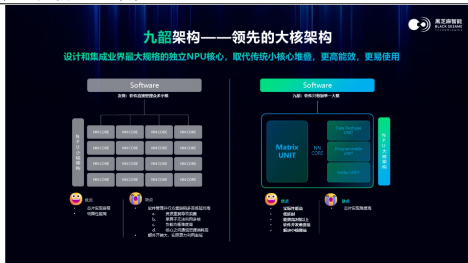
图 63：黑芝麻的NPU架构
