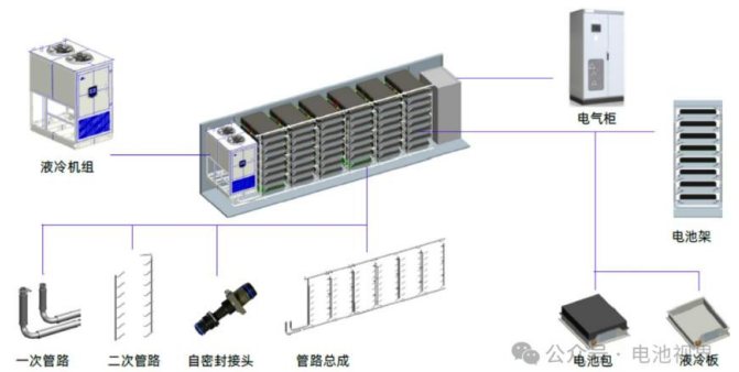
图23: 储能液冷系统组成
