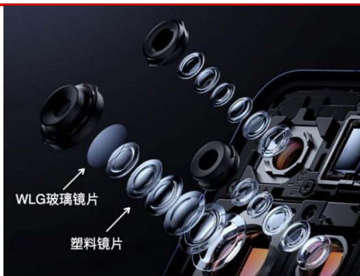
图 21 小米 MIX Fold4 采用玻塑混合镜头
