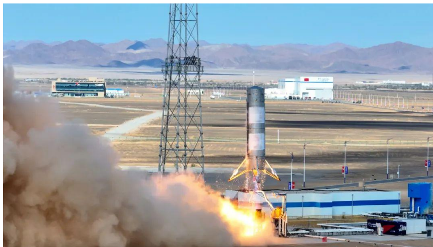
图：蓝箭航天朱雀三号VTVL-1首次实现十公里级垂直起降返回飞行试验
