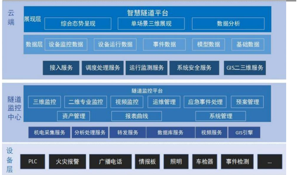
图15：隧道监控系统的示意性架构图如下
