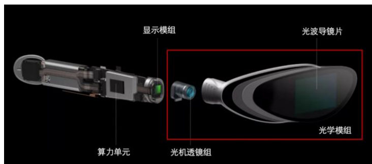
图表 54：AR 眼镜结构拆分（以 OPPO Air Glass 为例）
