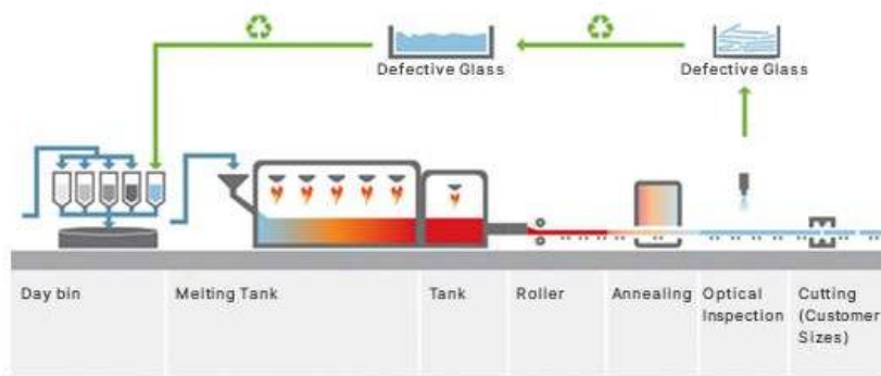
图表 33：肖特微晶玻璃采用辊制工艺，高温工艺实现晶体生长是关键
