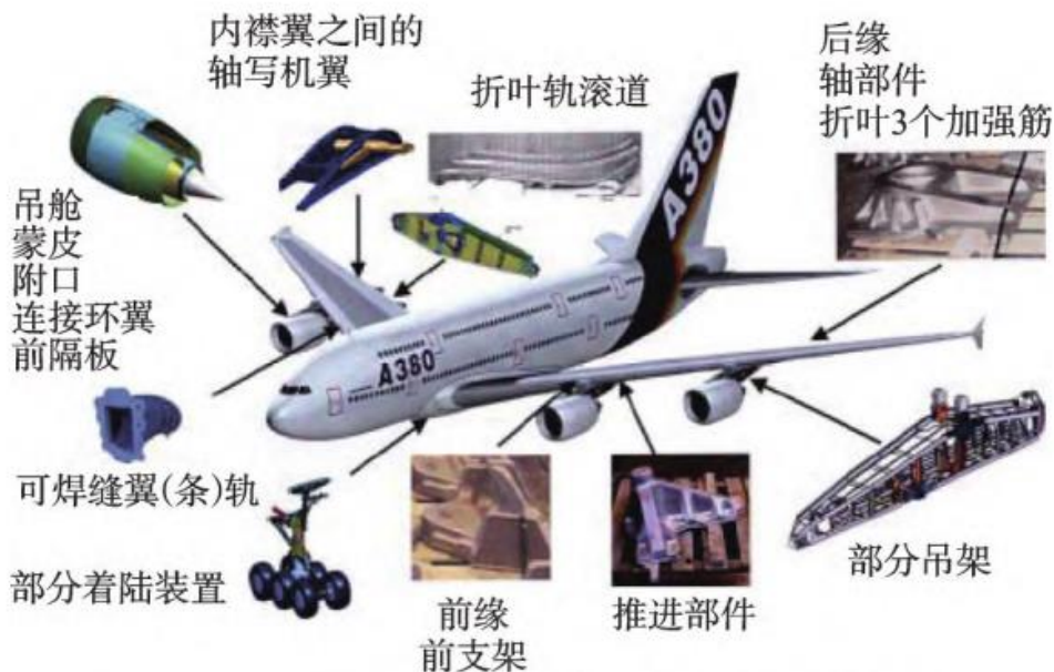
图17：A380 飞机使用钛合金的构件
