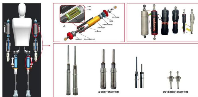
图 5：行星滚柱丝杠在人形机器人中应用示意图
