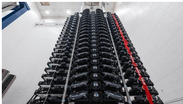
图表13: V2 Mini 卫星堆叠在猎鹰 9 号火箭有效载荷整流罩上的照片
