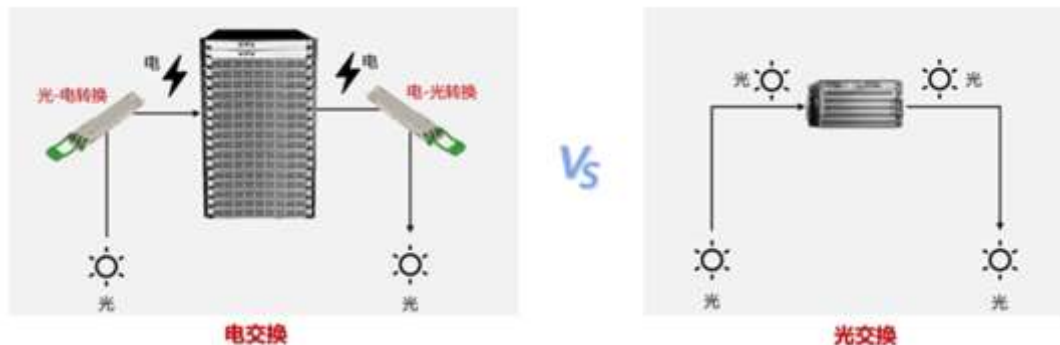
光电交换与光交换原理示意图
