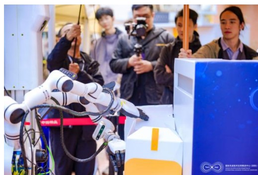
图21: 速腾聚创灵巧手成功完成外卖箱的折叠及回收
