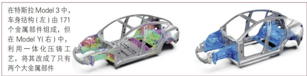
图11：特斯拉首创一体化压铸技术进行结构优化设计
