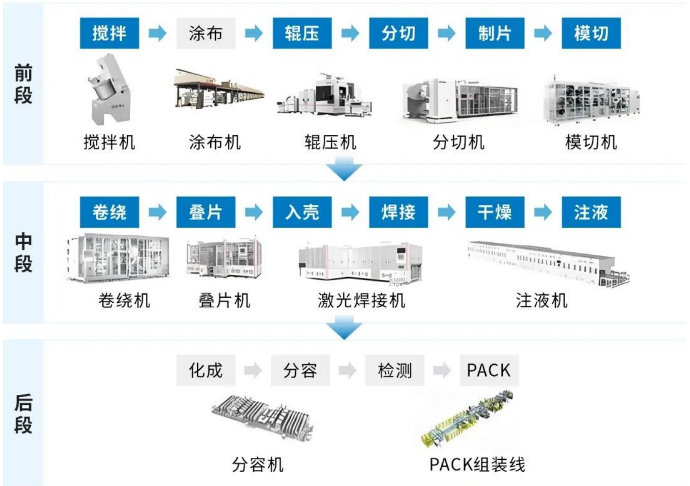
图 21 锂电池制造流程图
