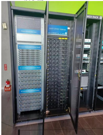
图：麦米在GTC2025 展示的800V HVDC Sidecar机架
