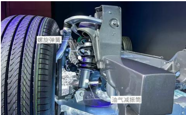
图29：比亚迪仰望 U8 悬架系统采用螺旋弹簧+油气弹簧的复合弹簧结构
