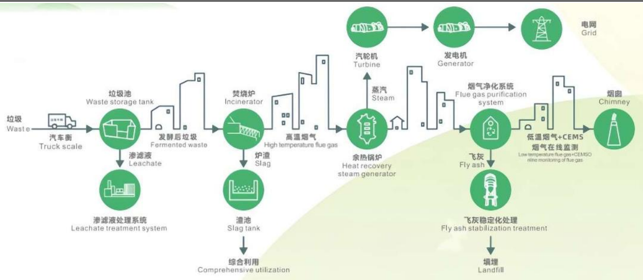
图 2: 垃圾焚烧发电厂的工艺流程
