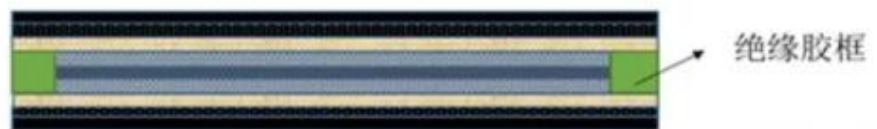
图8：公司布局 UV 固化绝缘胶框，保护固固界面完整性
