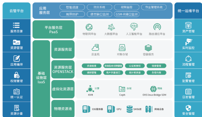
图8：佳讯飞鸿“飞鸿云”云计算平台架构
