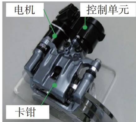
图表36：EMB系统实物图
